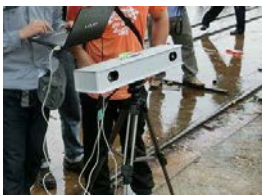
図1 船型取得用 3D カメラ 図2 船体にマーキングを施した 3D カメラによる撮影対象船(ミャンマー) 図3 3DCAD によるモデリング(ミャンマー漁船)
